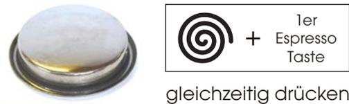
3. Duschsieb runterschrauben, reinigen, handfest hochschrauben.
