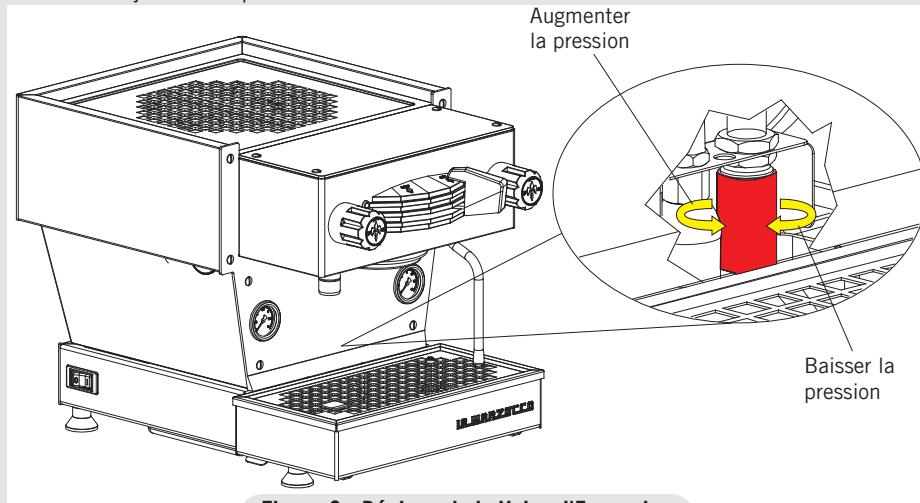
Figure 2 - Réglage de la Valve d'Expansion
