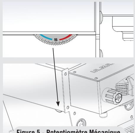
**Figure 5 - Potentiomètre Mécanique**
